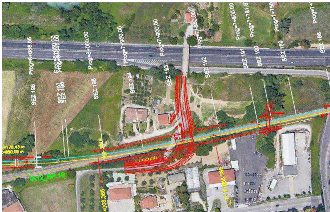
Il tracciato è stato progettato con una velocità di progetto massima utilizzata per le verifiche pari a 30 km/h; considerato inoltre la funzionalità della strada e che si ha un limitato numero di abitazioni da servire anche il limite di velocità adottato sarà di 30 km/h.
