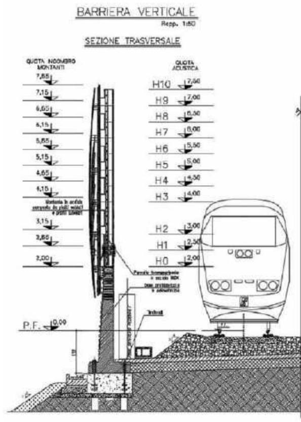
Figura 5-12 Altezze dal binario (piano del ferro) delle sezioni-tipo delle barriere tipologiche RFI
