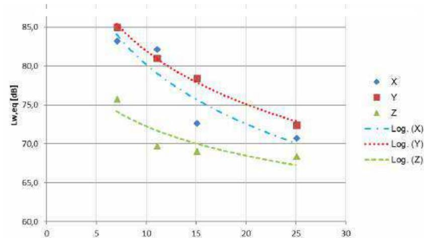
Figura 5-10 Esempio di curve e funzioni di attenuazione lungo gli assi X, Y, Z
