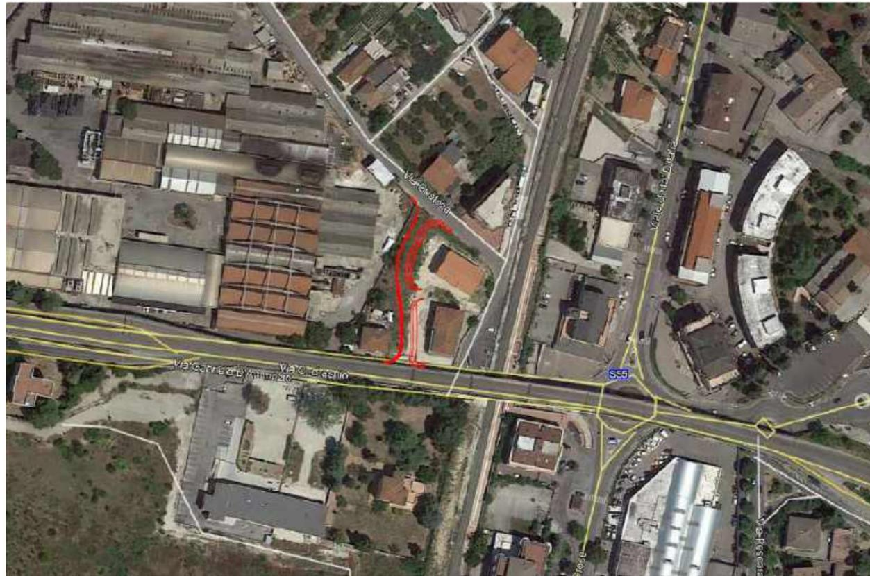
L'ampiezza della piattaforma stradale è stata individuata in conformità con quanto prescritto dal DM 2001 che indica per una strada a senso unico una larghezza pari a 5,50 m. Considerando la presenza della fermata, tale viabilità verrà utilizzata anche da quell'utenza che ha la necessità di raggiungere la stessa; pertanto, si evidenzia la necessità di individuare un corridoio che risulti sufficientemente ampio per garantire il transito in sicurezza di veicoli e pedoni.
