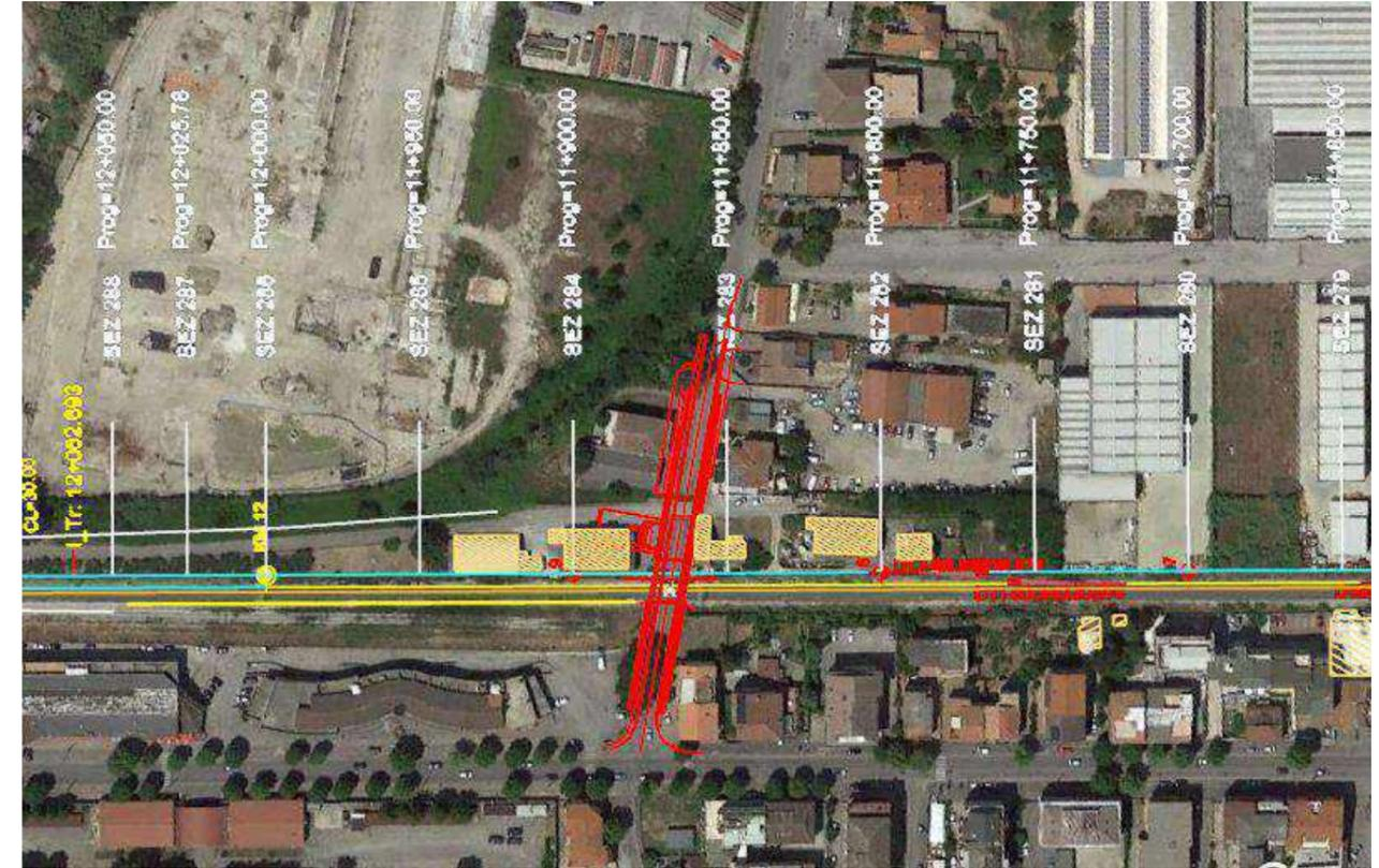
La soluzione progettuale proposta prevede il superamento dell'interferenza con la ferrovia sempre attraverso la realizzazione di un sottovia scatolare, ma che garantisca almeno un franco verticale non inferiore a 3,20 m, pendenze longitudinali massime del 10 % e raccordi verticali di adeguato sviluppo tali da garantire una distanza di visuale libera utile per l'arresto.
