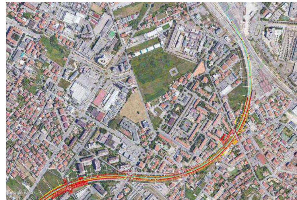
Dal km 1+782,711 fino al km 2+038,498 il raddoppio viene eseguito sul lato sinistro del binario storico, con il binario dispari di progetto posto a 5,50 m dalla LS; nella "zona di transizione" compresa tra il km 1+634,179 ed il km 1+782,711 i binari di progetto della nuova linea intersecano quello della LS; pertanto, le lavorazioni andranno eseguite in interruzione di esercizio.
