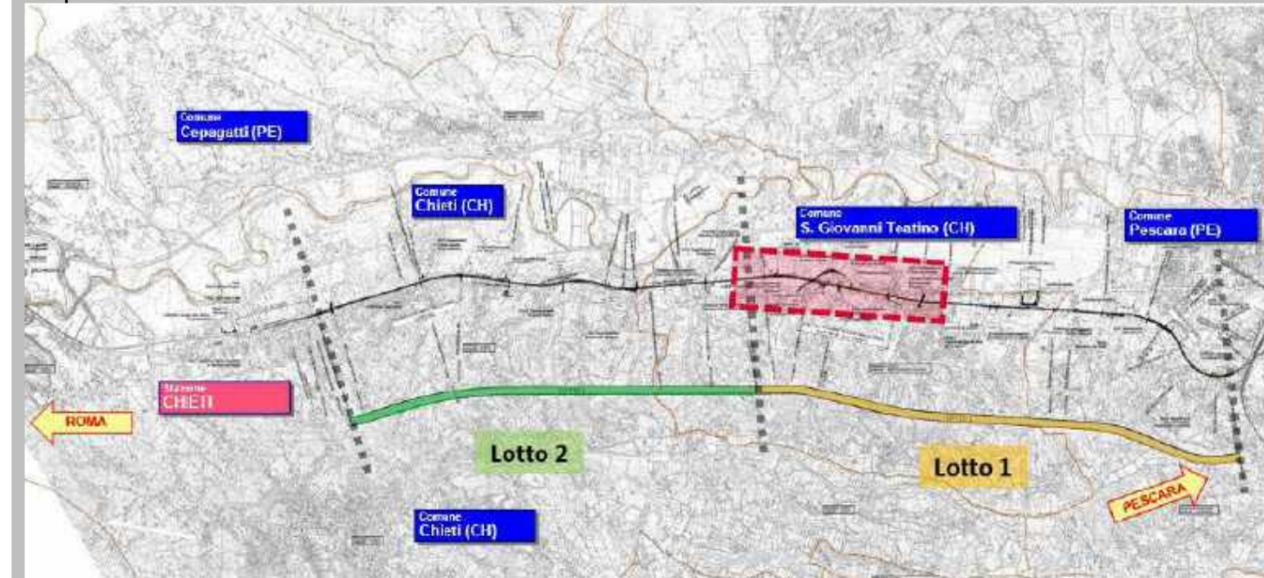
L'approfondimento progettuale richiesto presenta una variante caratterizzata dall'interrimento della linea ferroviaria mediante la realizzazione di una galleria artificiale di lunghezza pari a 560 m, posizionata tra le viabilità Corso di Italia e Sandro Pertini.
