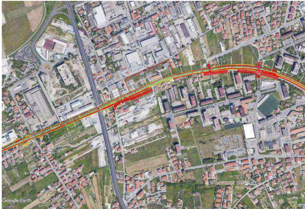
Tra il km 1+782,711 ed il km 2+038,498 il raddoppio in stretto affiancamento viene realizzato sul lato sinistro, con interasse non inferiore a 5,50 m tra binario dispari di progetto e LS.
