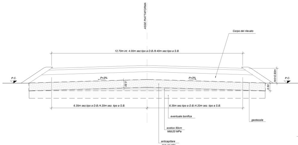
Sezione tipo in rilevato -  $0,90m \leq H_{ril} < 1,10$  m
