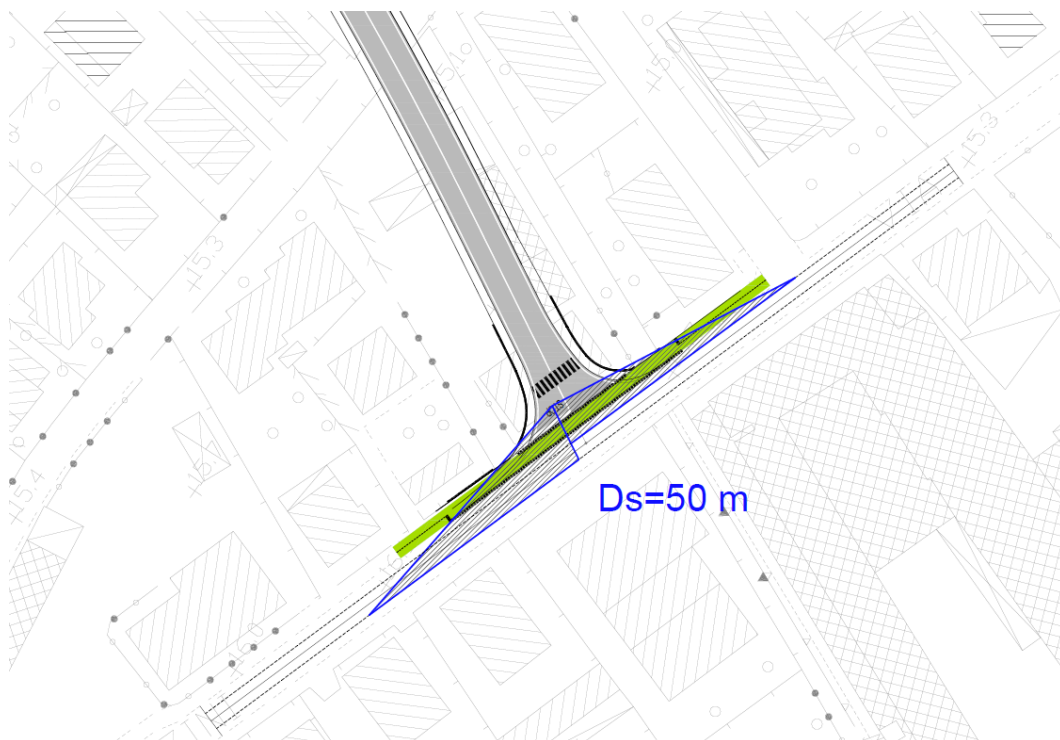
Figure 32 - innesto su Via Mazzini con triangoli di visibilità considerando un limite di velocità pari a 30 km/h
