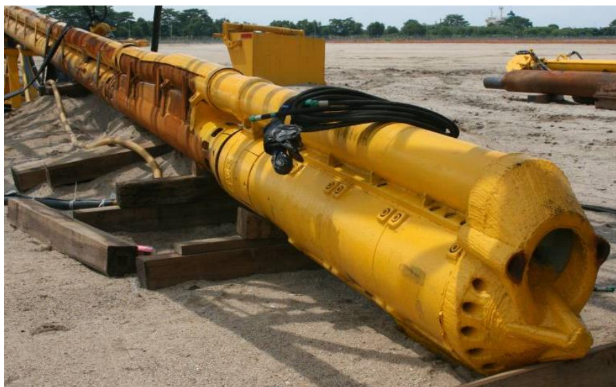
Figura 6: Tipica attrezzatura per colonne di ghiaia con immissione della ghiaia a secco a fondo foro – Dettaglio della punta dell'utensile (nota ugelli per l'iniezione di acqua o aria) e tubo di consegna ghiaia
