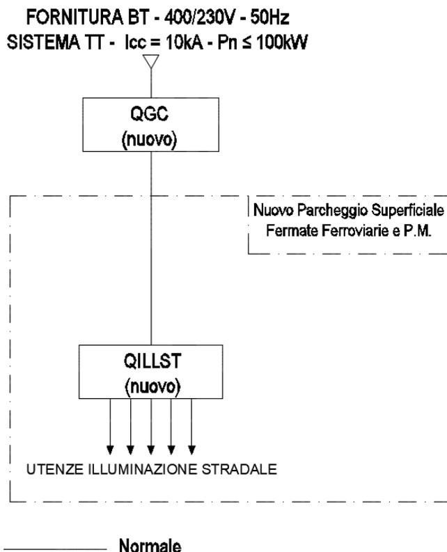
Figura 4 – Schema elettrico parcheggi superficiali delle fermate ferroviarie e P.M. con nuova fornitura in BT
