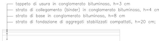
**Dettaglio 2 - Pavimentazione pista ciclabile e marciapiede (rialzato e a raso)**
