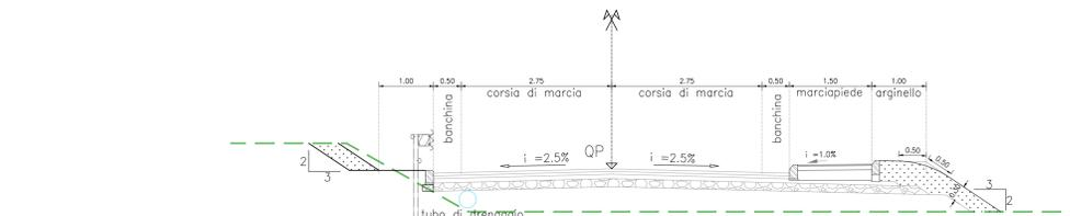
**Dettaglio 1 - Pavimentazione stradale tipo 1**
