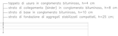
**Dettaglio 3 - Pavimentazione pista ciclabile e marciapiede (rialzato e a raso)**
