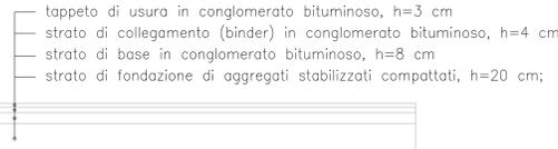
**Dettaglio 2 - Pavimentazione stradale tipo 2**
